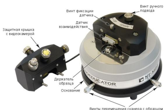
NanoEducator поддерживает все базовые методики атомно-силовой и сканирующей туннельной микроскопии, поэтому он может быть использован для любых АСМ и СТМ измерений и экспериментов в научных исследованиях:
